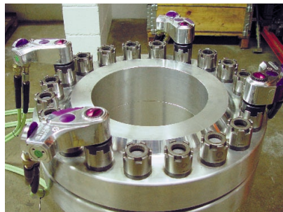
ISS-SIMULTORQUE: Flensdelen met een kritische afdichting worden zo in een zeer korte tijd parallel dichtgetrokken.
