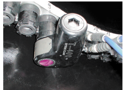
Veiligheid en Nauwkeurigheid op en top: Handenvrij draaien, ondersteboven (want de sleutel hangt aan de moer) tot op 90% van de voorspanspankracht van 12,9 bouten op een draaikrans van een kraan.
