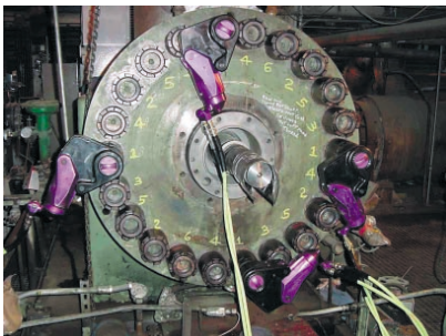
ISS-SIMULTORQUE: Handenvrij voorspannen op 890 kN incl. schriftelijke registratie voor elke bout voor elke passage
